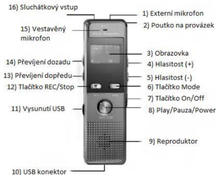
1) externes Mikrofon, 2) String-Schleife, 3) Anzeige, 4) Lautstärke (+), 5) Lautstärke (-), 6) Taste Mode, 7) Taste Ein/Aus, 8) Play/Pause/Power, 9) Lautsprecher, 10) USB Buchse, 11) USB auswerfen, 12) Taste REC/Stop, 13) schneller Vorlauf, 14) schneller Rücklauf, 15) eingebautes Mikrofon, 16) Kopfhörerbuchse
