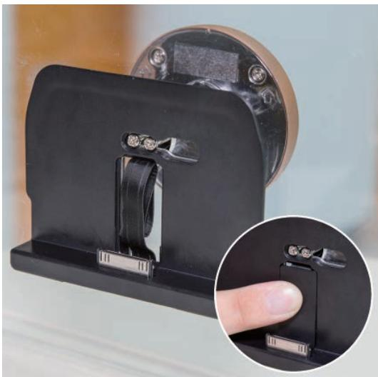
10. Richten Sie das FPC-Kabel unter dem Stecker aus und bringen Sie es durch leichtes Drücken wieder in seine ursprüngliche Position.
