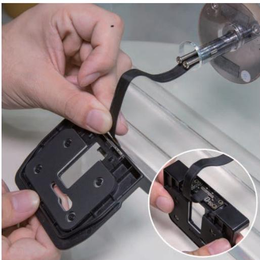
7. Schieben Sie den Stecker am FPC-Kabel vorsichtig in den Schlitz an der Unterseite der Halterung.
