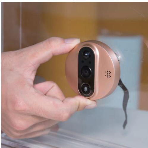
4. Kleben Sie die äußere Kamera mit Klebebandstreifen an die Tür.
