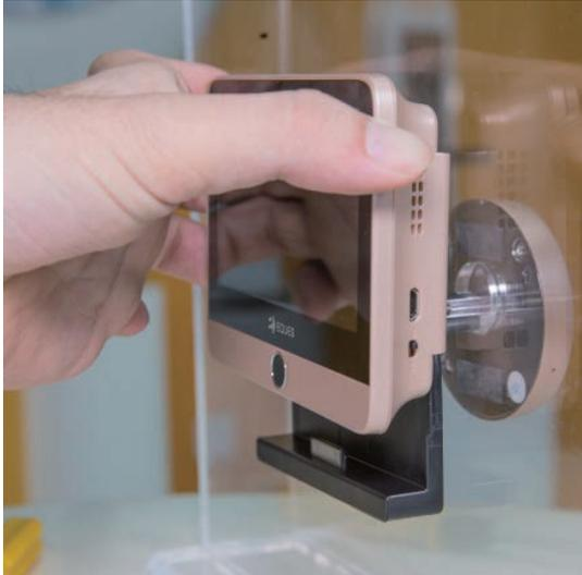
11. Schieben Sie den internen Monitor von oben nach unten auf die Halterung, um ihn mit dem Magneten zu sichern.
