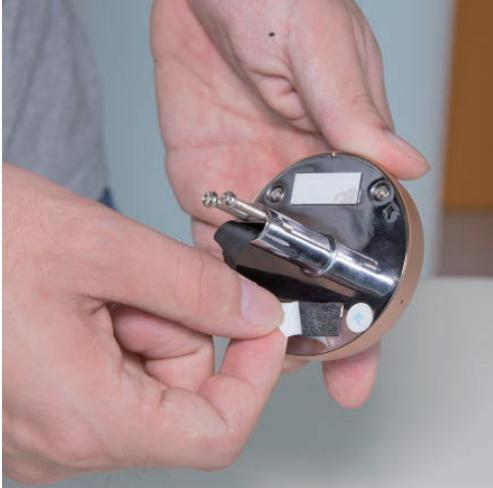
2. Entfernen Sie die Schutzfolie von den Klebebandstreifen auf der Rückseite der Außenkamera.
