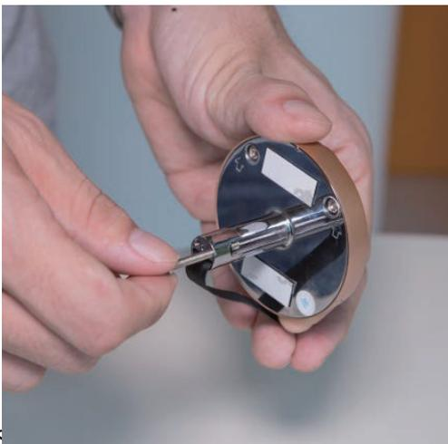
1. Wählen Sie die Schrauben mit der entsprechenden Länge entsprechend der Dicke der Tür aus und schrauben Sie sie in die Löcher in der Kamera (siehe Kapitel 6).
