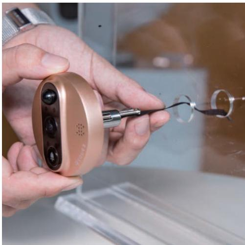
3. Führen Sie das FPC-Kabel durch das Loch in der Tür.
