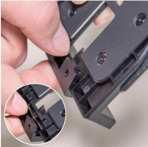
6. Entfernen Sie dann die Schutzplatte an der Unterseite des Halters.
