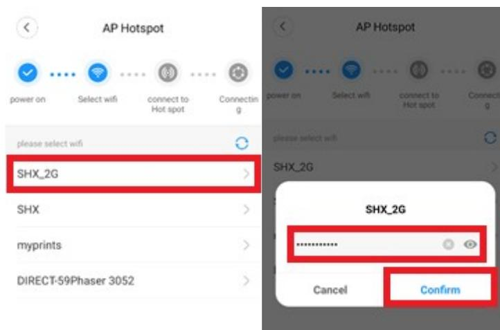
6. Sie werden aufgefordert, ein bestimmtes Gerät auszuwählen. Drücken Sie die Schaltfläche „**Connect AP spot**“ und bestätigen Sie. Sie werden zu den WLAN-Einstellungen weitergeleitet. Wählen Sie das WiFi-Netzwerk des bestimmten Geräts in der Form DVXXXXXXX aus und verbinden Sie Ihr Mobiltelefon mit diesem Netzwerk. Kehren Sie dann zur Anwendung zurück.
