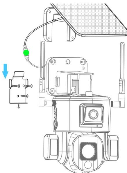
4 – Schließen Sie das Solarpanel an das Gerät an.
