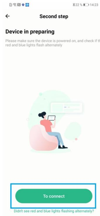
**Hinweis:** Wenn die Anzeige nicht abwechselnd rot und blau blinkt, überprüfen Sie, ob die Kamera eingeschaltet ist, und überprüfen Sie den Status der SIM-Kartenanzeige. Setzen Sie die Kamera ggf. zurück.
